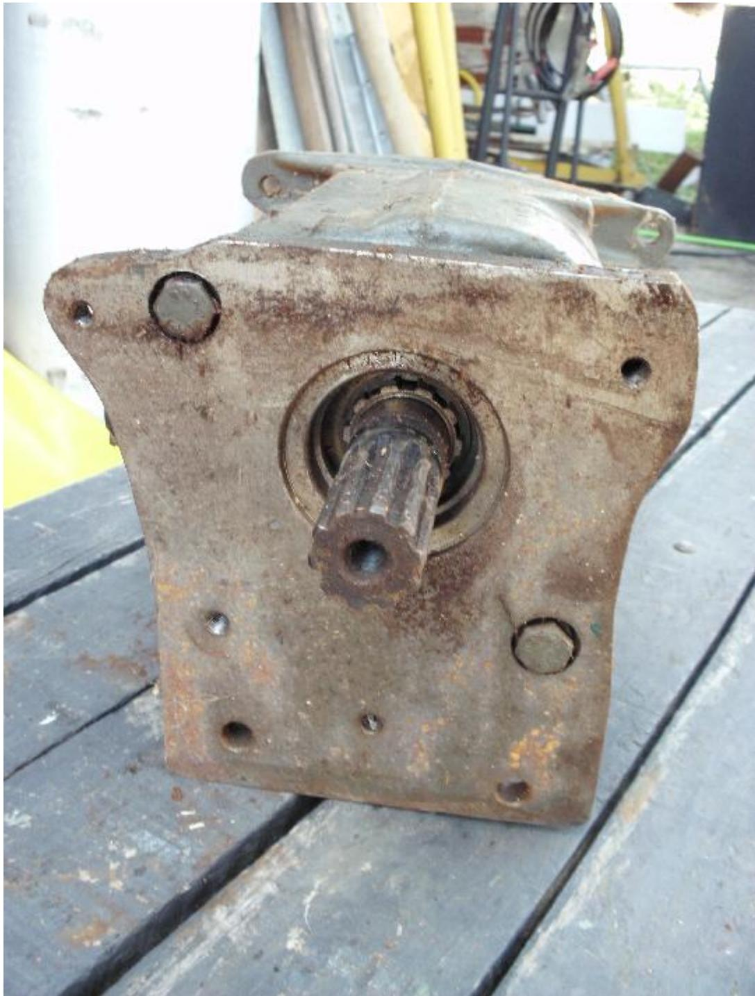
Flange com furação para adaptar caixa transferência; Transfer Case-TC Dana T18 (reduzida Jeep Willys).
