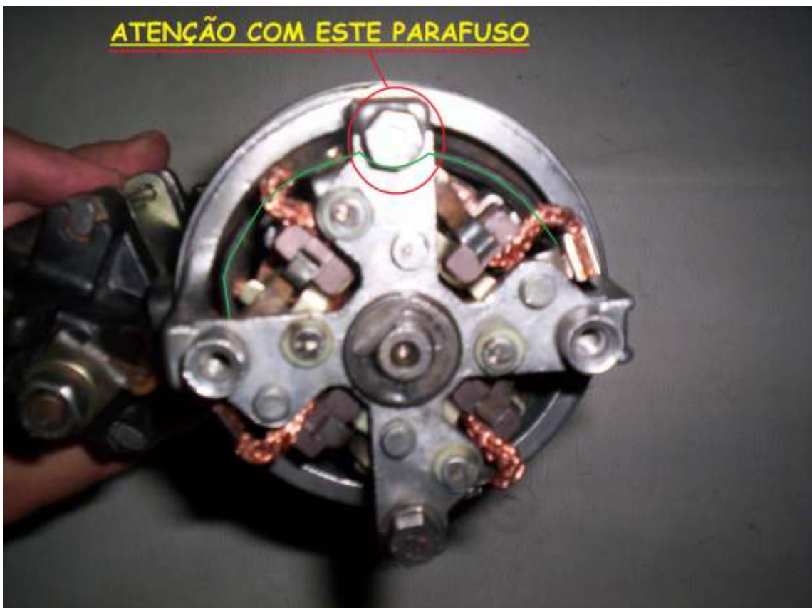
Passagem do parafuso de fixação. Os parafusos não devem encostar nas bobinas ou no jumper. Se necessário o mesmo deverá ser isolado por um tubinho plástico.
