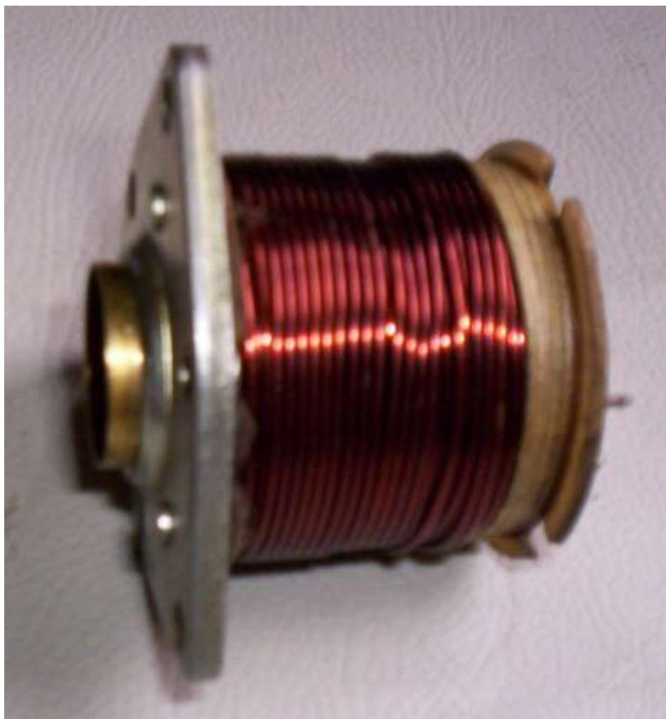
Tampa lado atuador colocada
