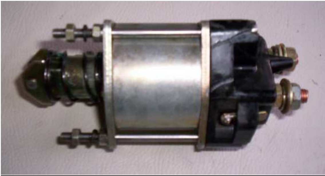
Solenóide montada. Cuidado ao apertar os três parafusos de fixação. Não empregar muita força para não quebrar a baquelite.
