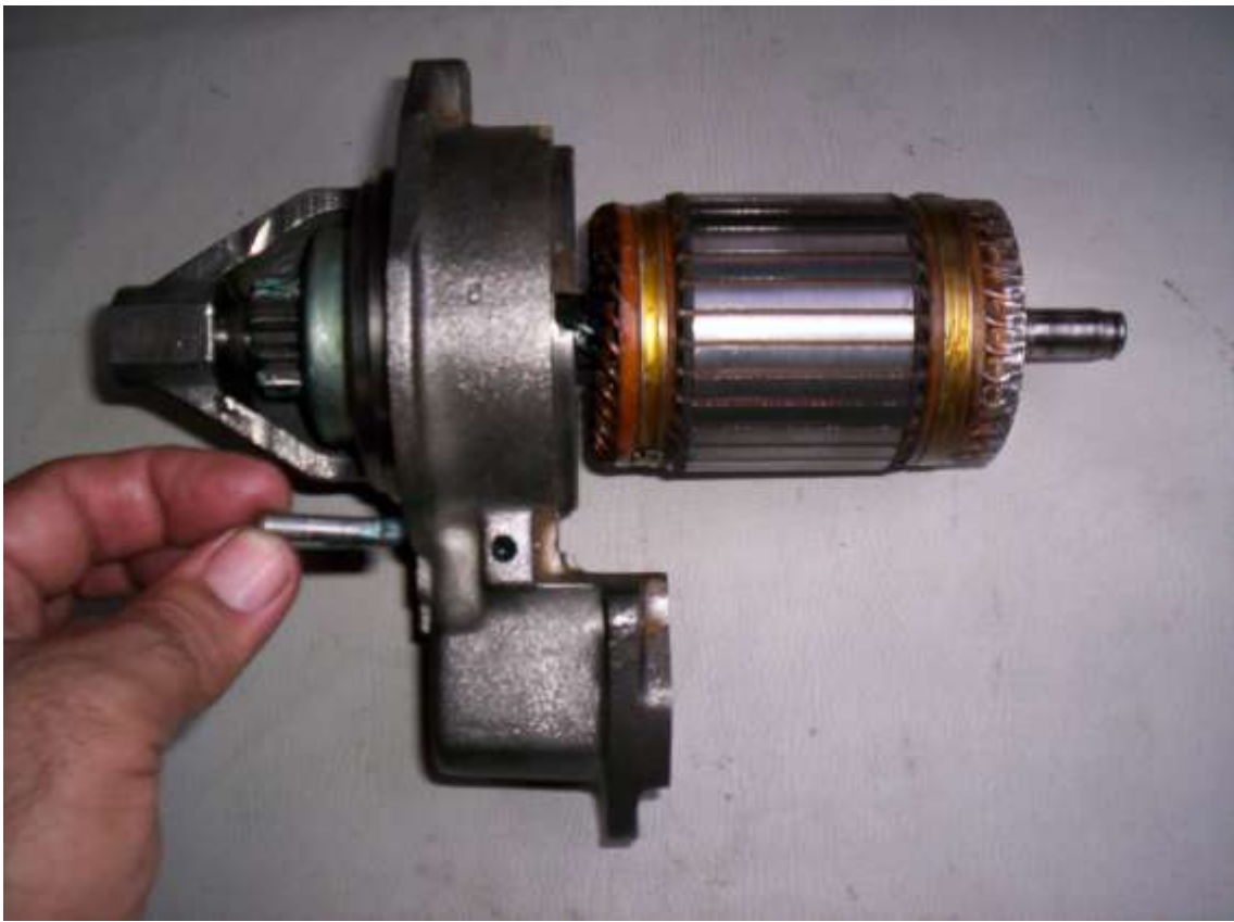
Colocação do eixo da alavanca de acionamento
