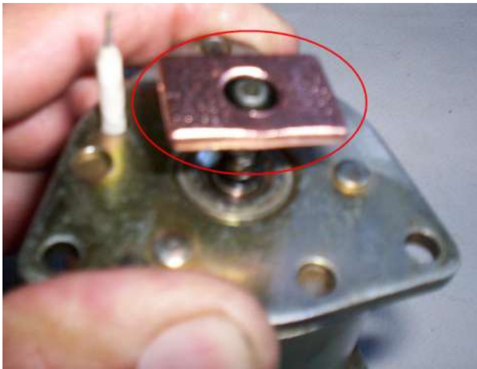
Placa de cobre (item 19). Se a face desta placa estiver áspera, lixar com lixa fina ou virá-la
