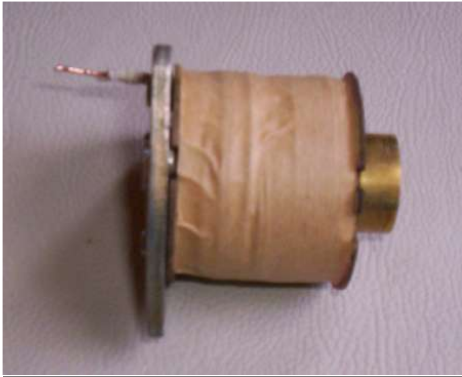
Bobina encapada com fita gomada
