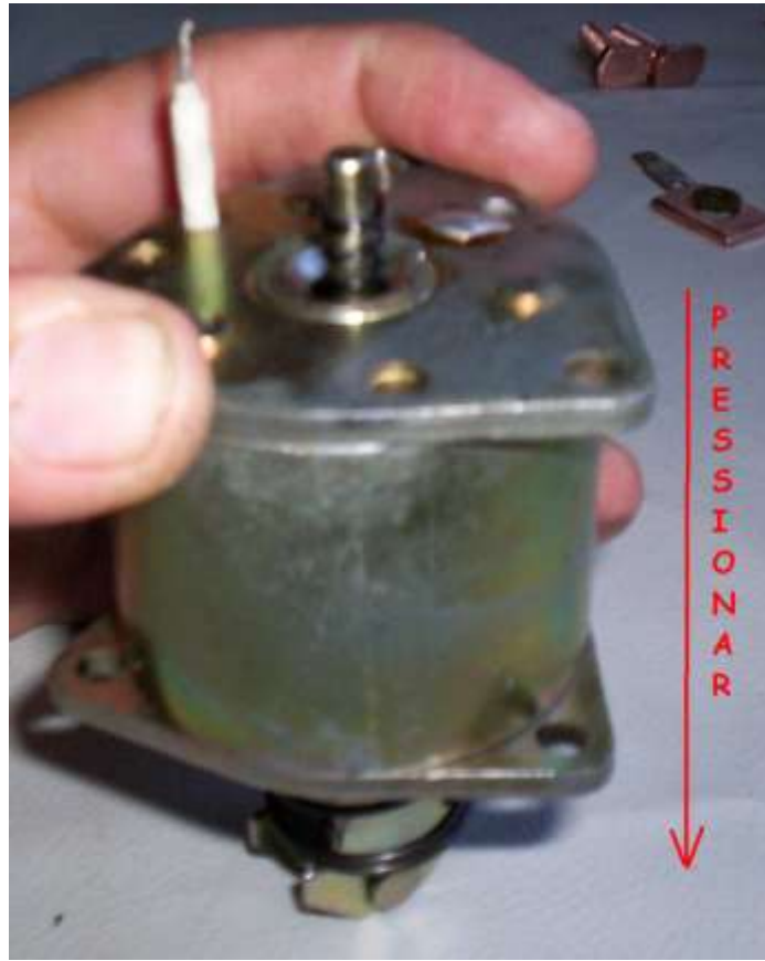
Eixo atuador colocado
