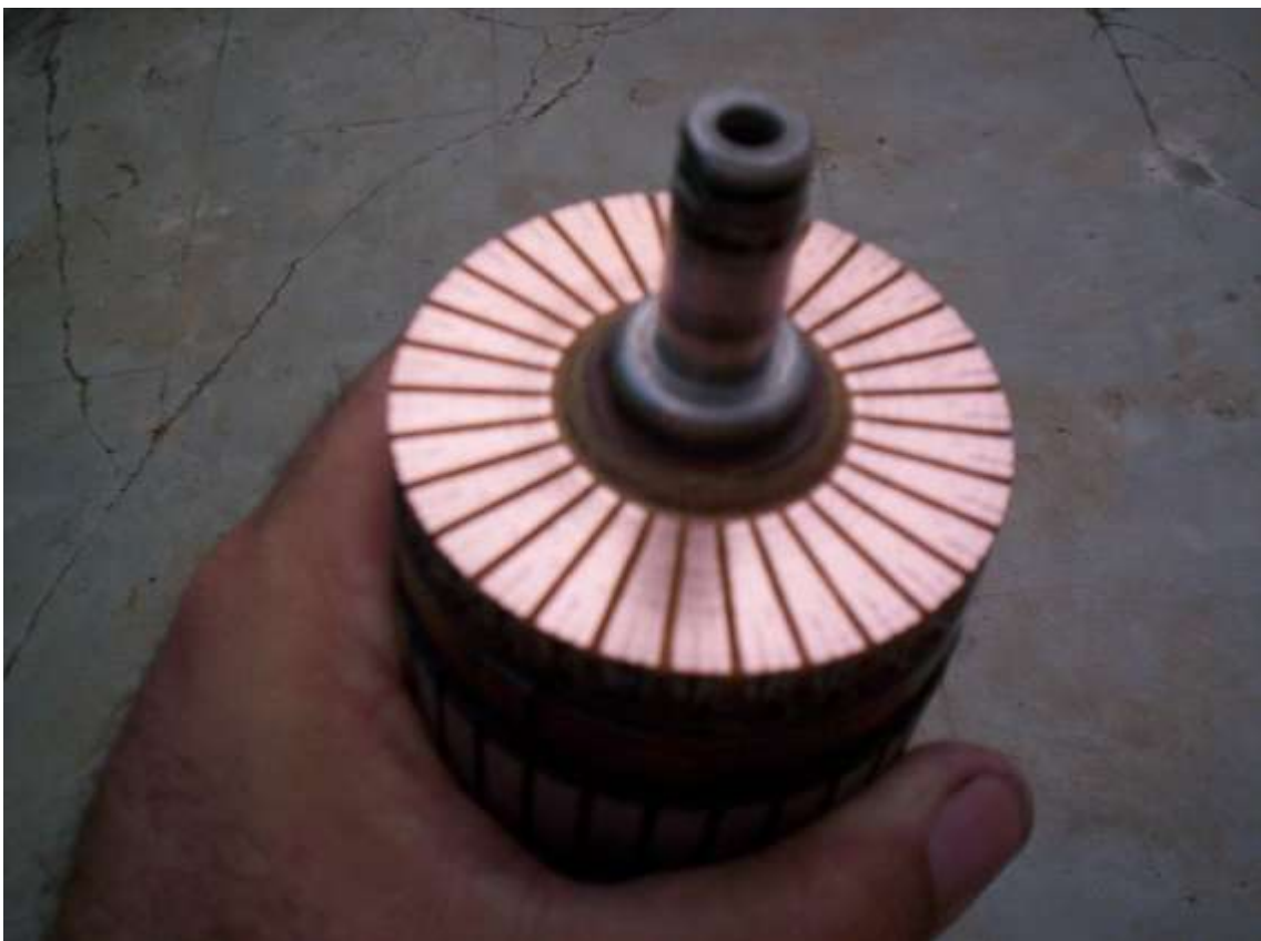
Coletor totalmente limpo
