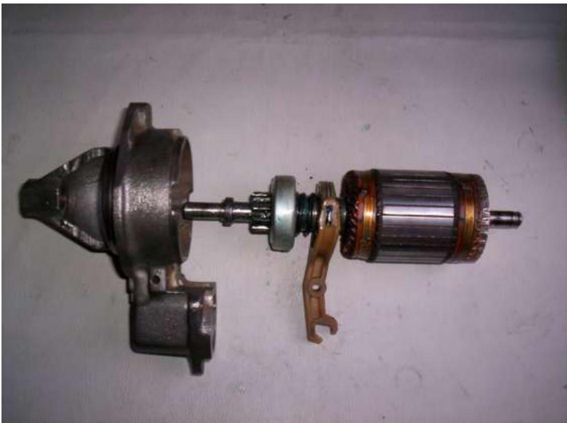
Colocação do mancal de acionamento
