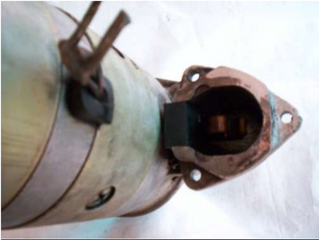
Motor de partida sem a solenóide
