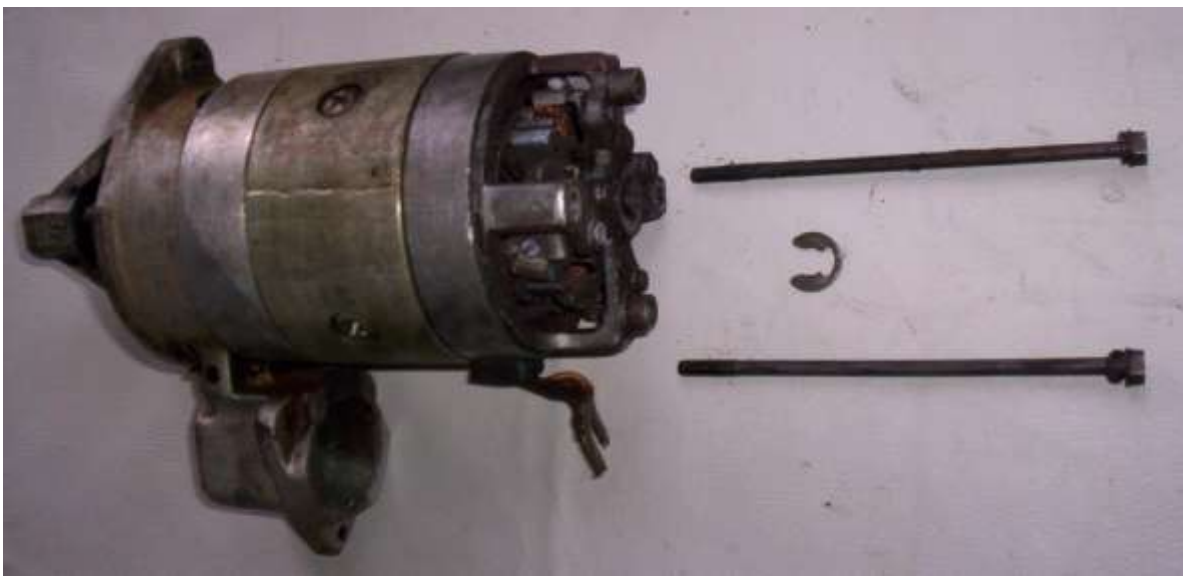
Retirada dos parafusos de fixação do conjunto e da trava do eixo do induzido
