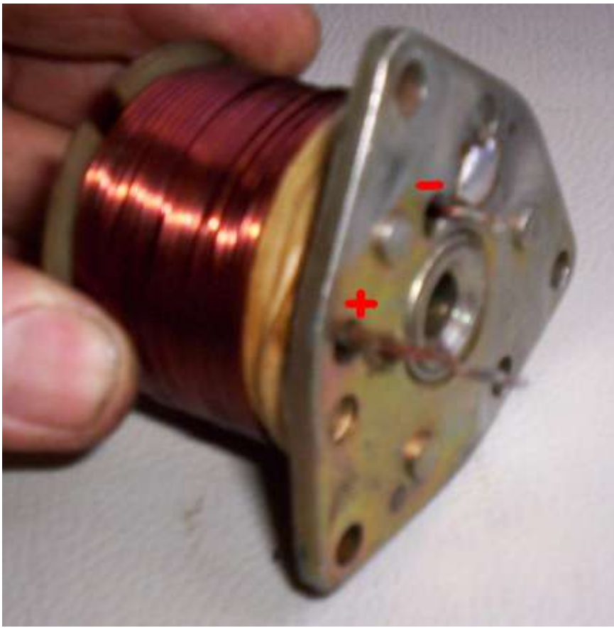
Tampa lado dos contatos (colocada)
