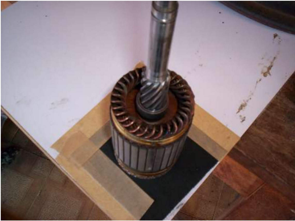
Lixa fixada na tábua e induzido posicionado
