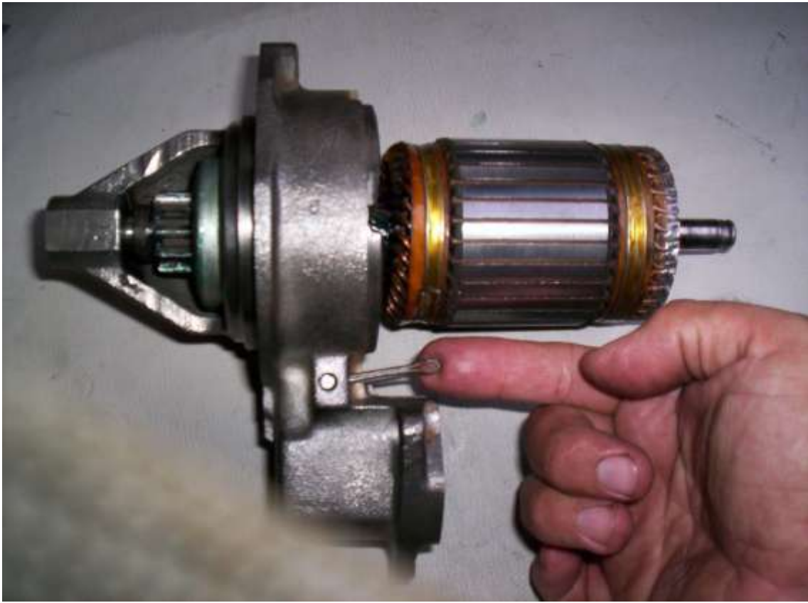
Colocação da trava do eixo
