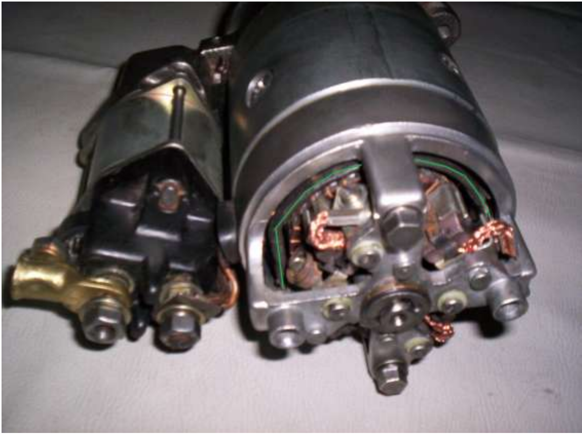
Posição do jumper do porta escovas tendo como referência o automático
