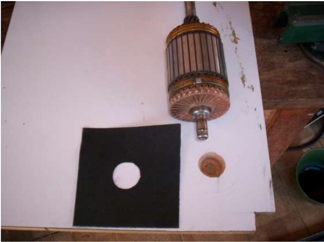
Tábua e um pedaço de lixa d'água (ambas com um furo para passar o eixo do induzido)
