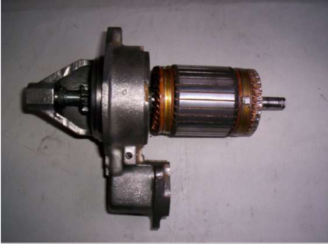
Mancal de acionamento colocado
