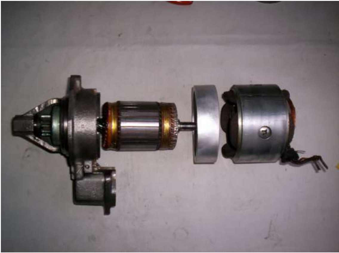
Colocação do espaçador
