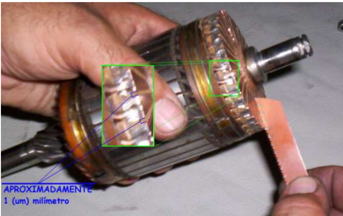
Coletor (rebaixamento e limpeza entre lâminas)
