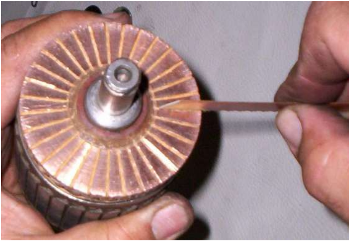
Coletor (rebaixamento e limpeza entre lâminas)
