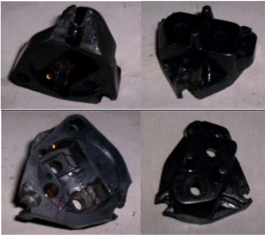
Baquelite quebrada por aperto excessivo
