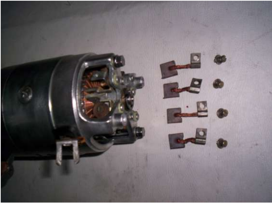
Colocação das escovas com o motor montado
