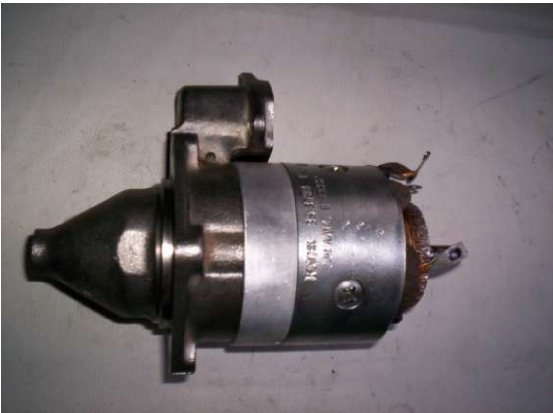
Colocação da carcaça polar (estator)
