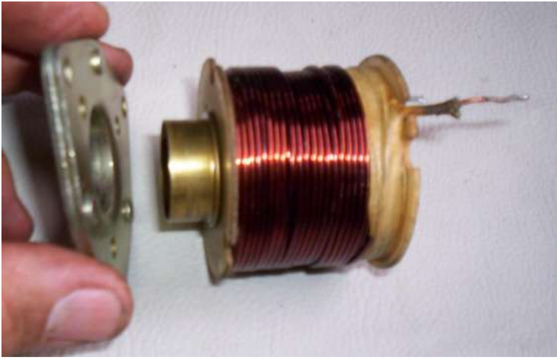
Tampa lado do atuador (colocação)
