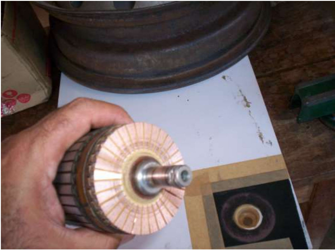
Coletor parcialmente limpo
