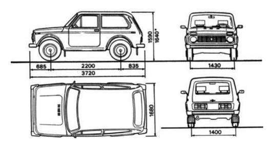
Raio mínimo externo de viragem (extremidade pára-choque dianteiro) 5,8m Distribuição do peso: Dianteira - 48% Traseira - 52%
