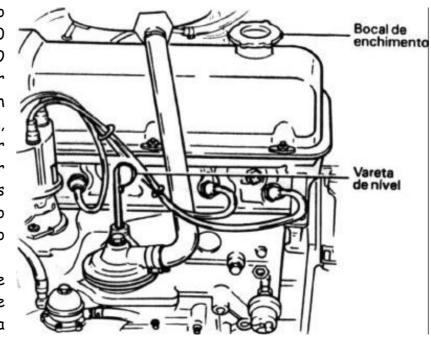
introduzida em seu alojamento. O nível deve ser mantido entre as marcas "min" e de "max" existentes na vareta. Se necessário, adicione óleo sempre do mesmo fabricante e da mesma viscosidade pelo bocal de enchimento.
