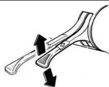
Esta alavanca opera nas posições **A** (para a direita) o **B** (para a esquerda). com retorno automático.
