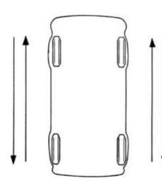
Para evitar o desgaste desigual dos pneus, faça o rodízio conforme o esquema ao lado. Os pneus devem rodar sempre do mesmo lado do veículo, observando obrigatoriamente o sentido de rotação.
