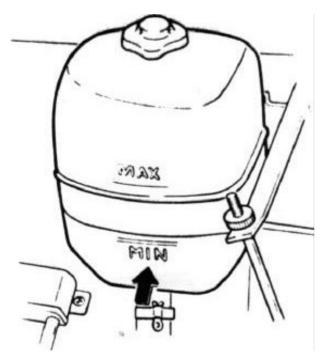
O sistema de arrefecimento é constituído por um radiador convencional e reservatório de expansão ligado ao radiador por um tubo flexível.
