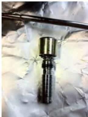
12. Instale êmbolo conjunto no modulador. Garantir que ele vai para baixo totalmente encaixado.
