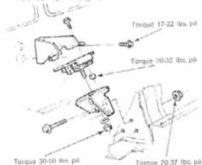
fig. 4 — instalação dos coxins dianteiros
