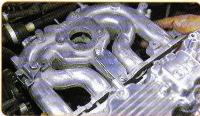
O coletor de admissão inteiramente polido é recolocado
