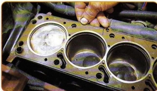
Antes de fechar o motor, troque a junta do cabeçote
